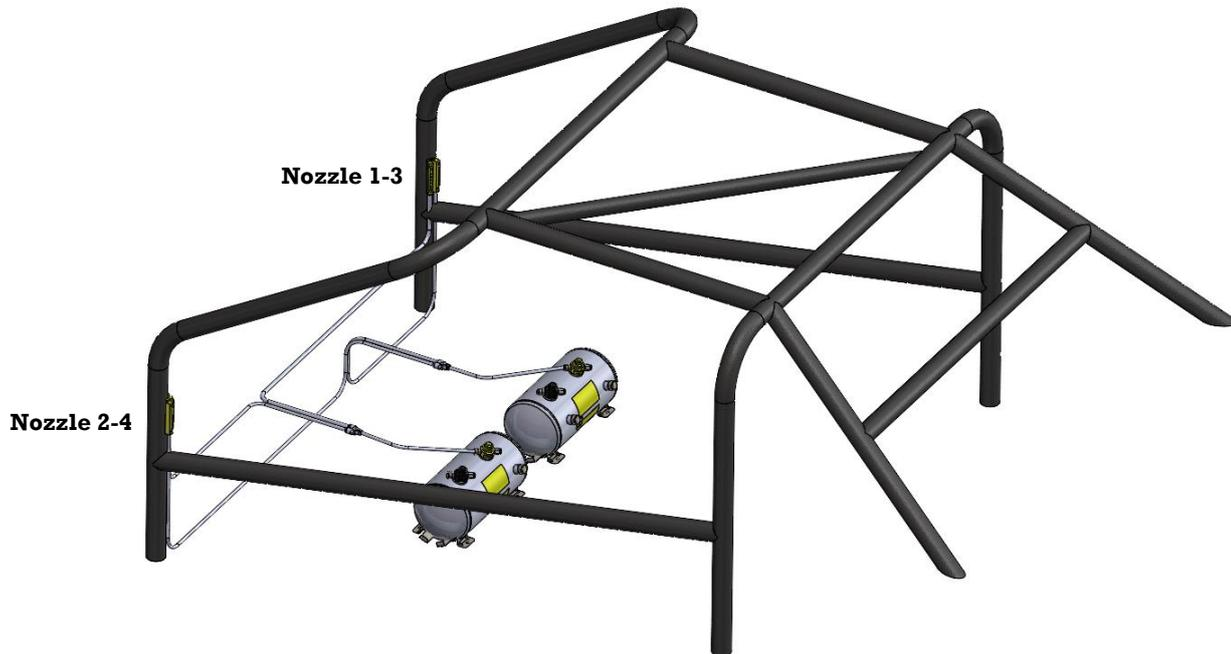
Fig. 1 Installazione in abitacolo di due impianti
